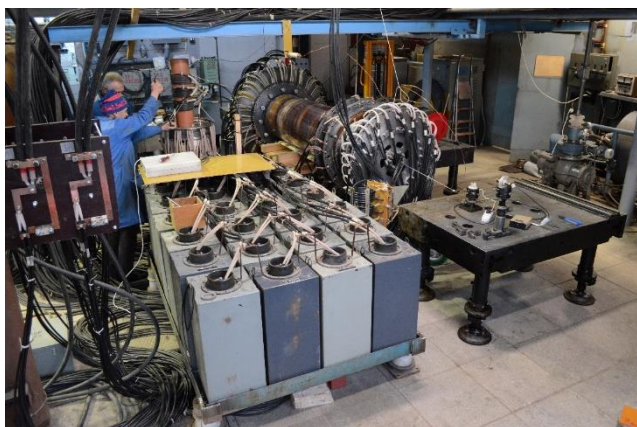
Лабораторный образец ИУПТ с источниками питания
