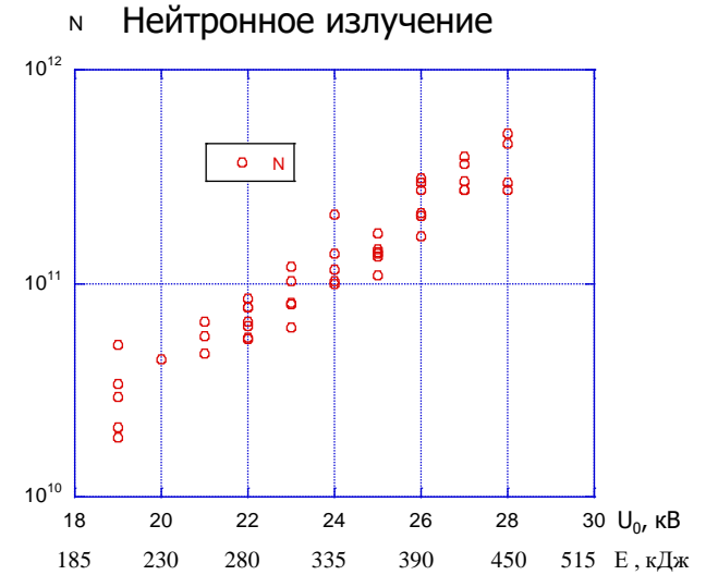
Зависимость выхода ДД нейтронов от энергозапаса в емкостных накопителях
