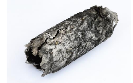
Алюминиевая оболочка после цикла сжатие-обратное расширение
