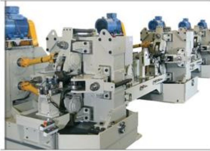
Производственная линия для получения глубоких профилей за 1 переход
