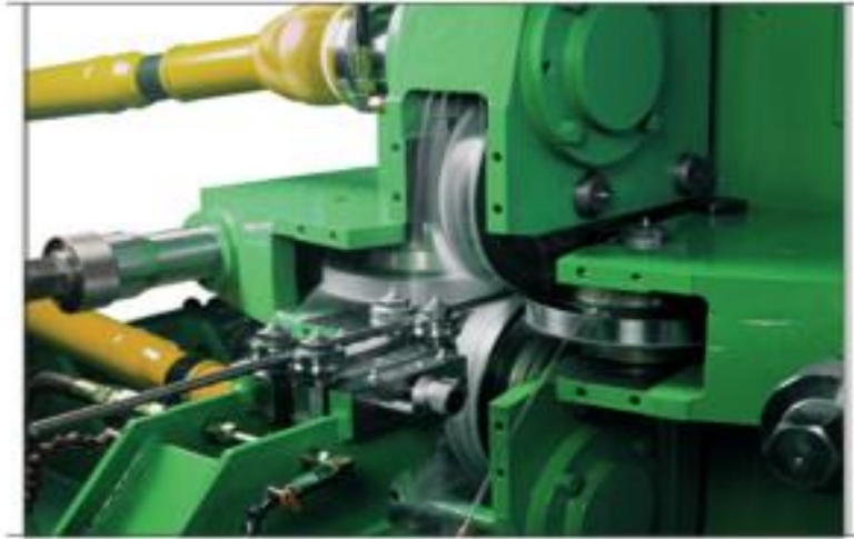
Формовочный блок с приводными фасонными роликами
