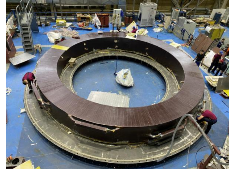
Пример изготовления – Катушка RF-1 ИТЭР
