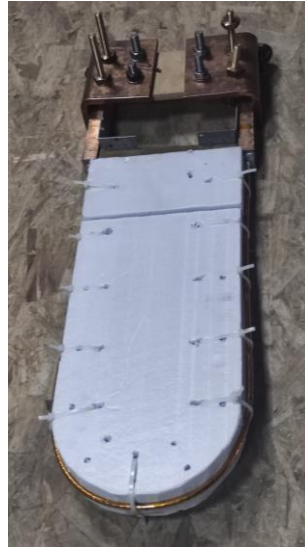
«Тонкий» CORC (Тип 1), изогнутый на оправке \varnothing 200 мм
