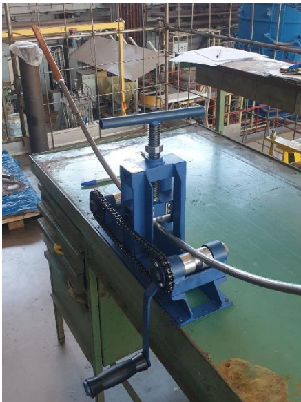
Последовательный изгиб на трехроликовом трубогибном станке
