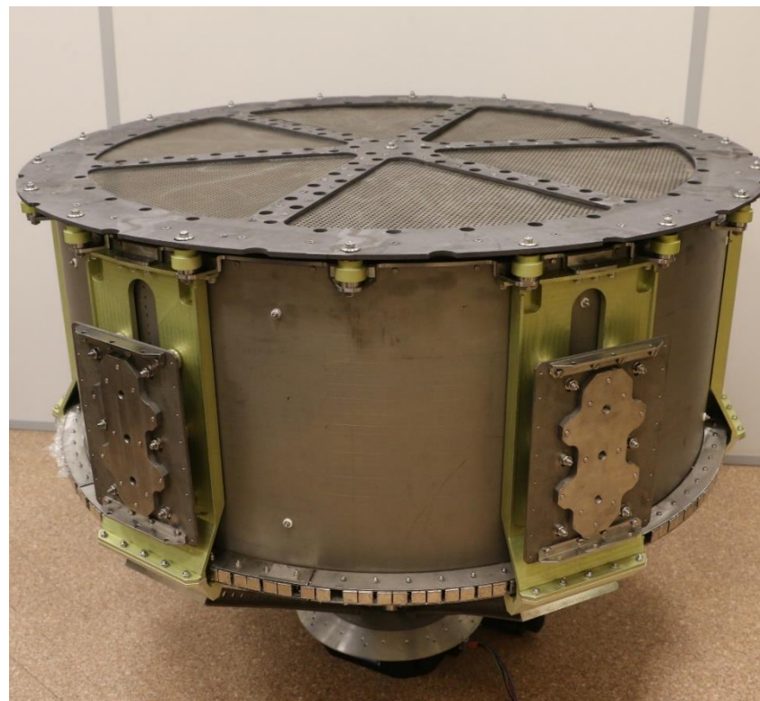
Макет ионного двигателя мощностью до 85 кВт (потенциально действующий) в сборе
