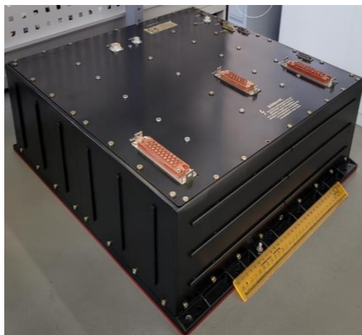
СПУ для двигателя КМ-10 (разработано АО НПЦ «Полюс» из собственных средств в 2021 году)
