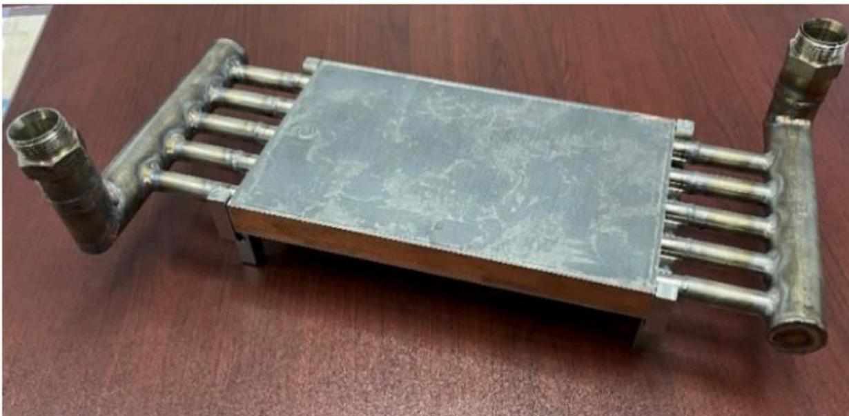
Изготовлена биметаллическая пластина со слоем стали (0,2 мм) с водяным охлаждением.
