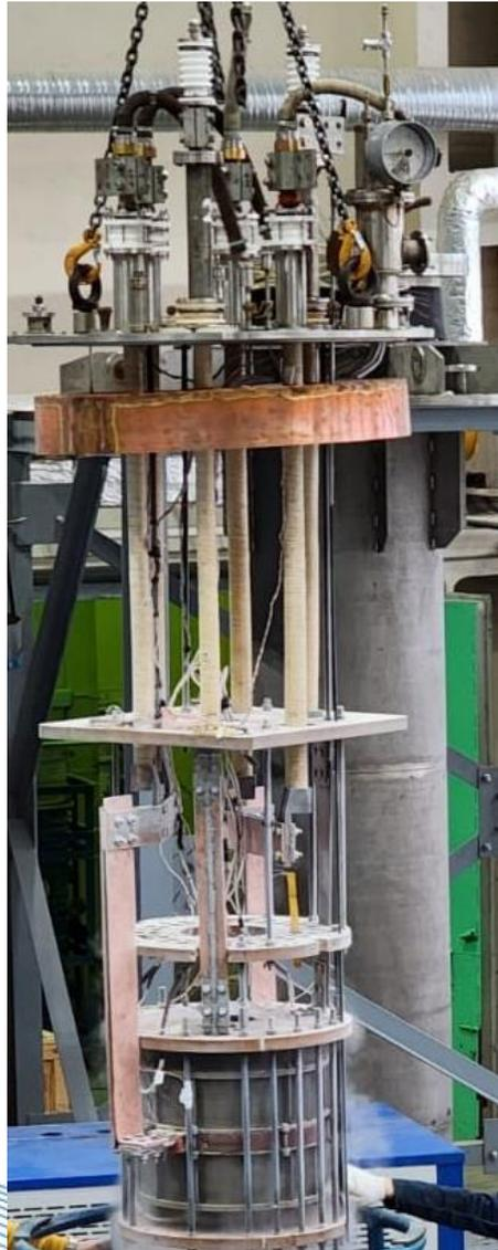
фланец криостата с токовыми вводами, вводами азота и гелия, и с диагностическим и выводами
