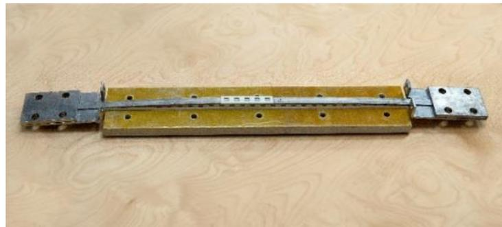
ВТСП-2 провод типа «Столпка ВТСП-2 лент в кожухе»
