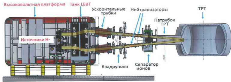
Схема инъекции нейтральных пучков в ТРТ (вид сбоку)
